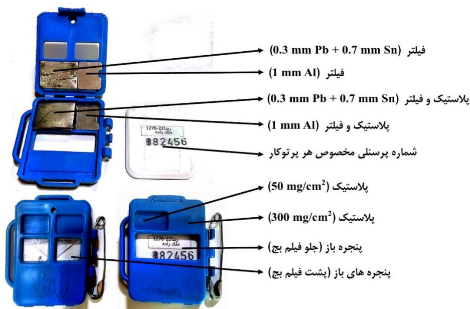
شکل ۲ دوزیمتر فیلم بج و اجزای آن.
