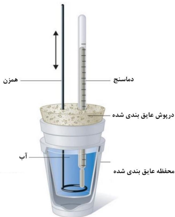
شکل ۲ ساختمان یک کالریمتر ساده غیر الکتریکی مورد استفاده در این آزمایش
